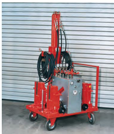
Machine de levage synchrone pour charges de 80 t max.
