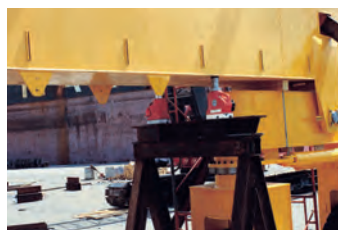
78JAH 630C. Levage sur tête et pied avec talon
