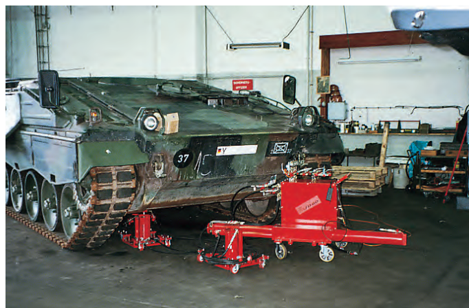
Machine de levage mobile pour véhicules à chenilles
