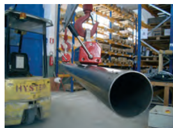
Pour la manutention des tôles et tubes d'épaisseur fine.
