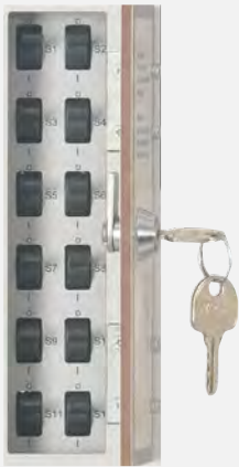
Simulateur de défaut avec 12 défauts possibles par commutateur
